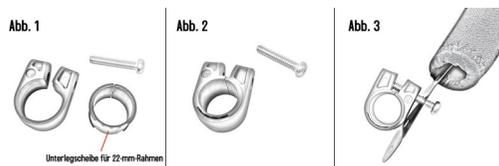
Um den FlexiFix-Arm an einem Rollstuhl zu befestigen, der keine existierenden Löcher im Rahmen hat, verwenden Sie eine Frame-Saver-Klemme. Diese können separat bei Active Hands erworben werden. messen Sie den Durchmesser Ihres Rollstuhlrahmens an der Stelle, an der Sie den Gurt befestigen möchten. Verwenden Sie bei einem 25-mm-Rahmen nur den Außenring. Bei einem 22-mm-Rahmen müssen Sie die in Abbildung 1 gezeigte Unterlegscheibe einsetzen.
