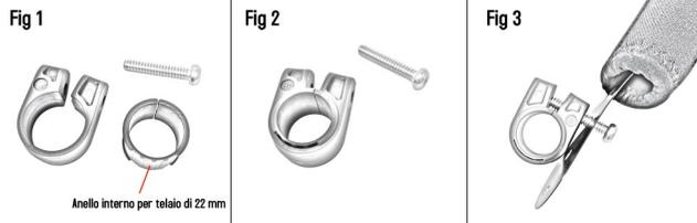
Per montare il morsetto, misurare il diametro del telaio nel punto in cui si vuole montare la cintura. Per un telaio di 25 mm, usare solo l'anello esterno. Per un telaio di 22 mm, inserire l'anello mostrato nella Figura 1.
